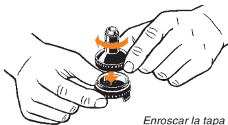
Enroscar la tapa de la cámara de relleno
