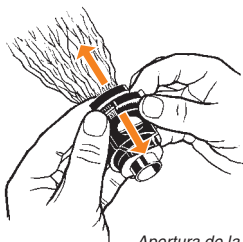
Apertura de la pinza de sujeción del globo
